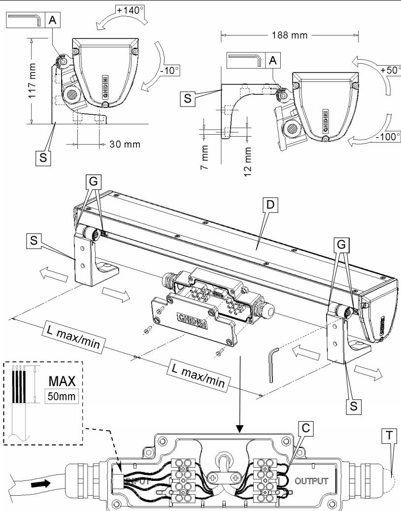
Fije el aparato según la necesidad colocando en la planta de apoyo (pared, cornisa, suelo o techo) los dos estribos (S) anteriormente unidos con 4 tornillos Ø6 (NO suministrados).
