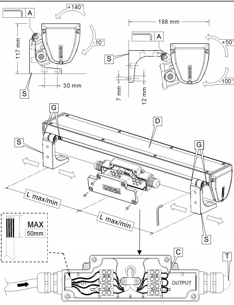
Procedere al fissaggio dell'apparecchio secondo esigenze fissando al piano di sostegno (muro, cornicione, pavimento o soffitto) le due staffe (S) preassemblate tramite 4 viti Ø6 (NON fornite in dotazione).
