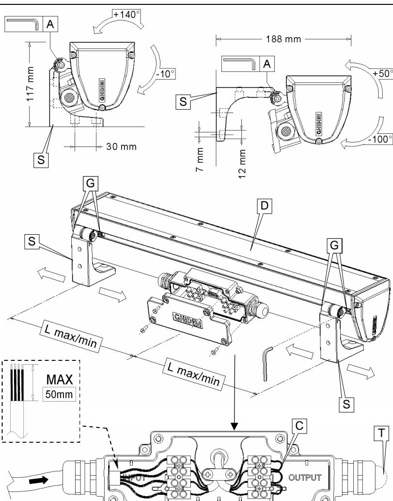
Die Befestigung des Geräts je nach örtlichen Gegebenheiten vornehmen, wobei man die beiden vormontierten Bügel(S) unter Verwendung von 4 Ø6 Schrauben (NICHT mitgeliefert) an die entsprechende Unterlage (Wand, Gesims, Boden oder Decke) schraubt.
